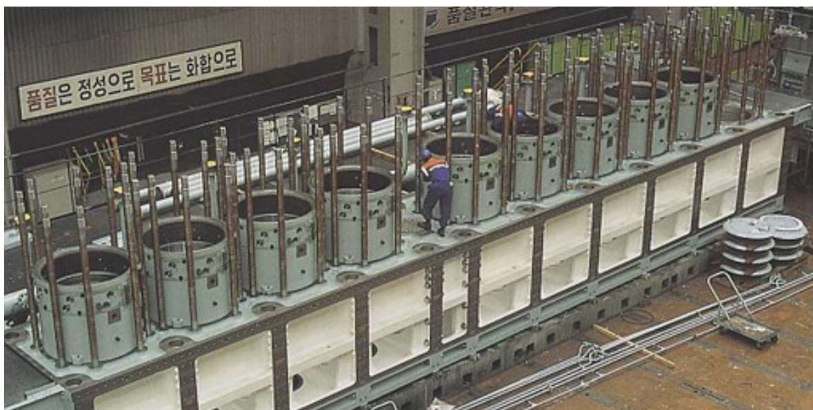
Manshoge cylinders voor immense dieselmotoren t.b.v. een olietanker.
